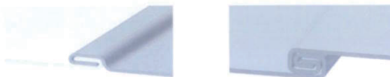
III. 4-11 Exemple: assemblage par pliage simple ou double
