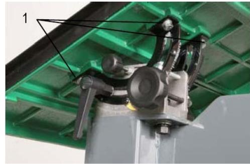
Fig. 5 : Montage de la table de sciage
