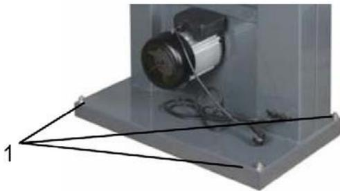
Fig. 4 : Montage sur le substrat
