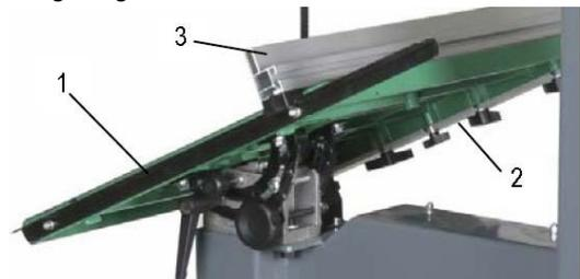
Fig. 6 : Assemblage du guide de feston
