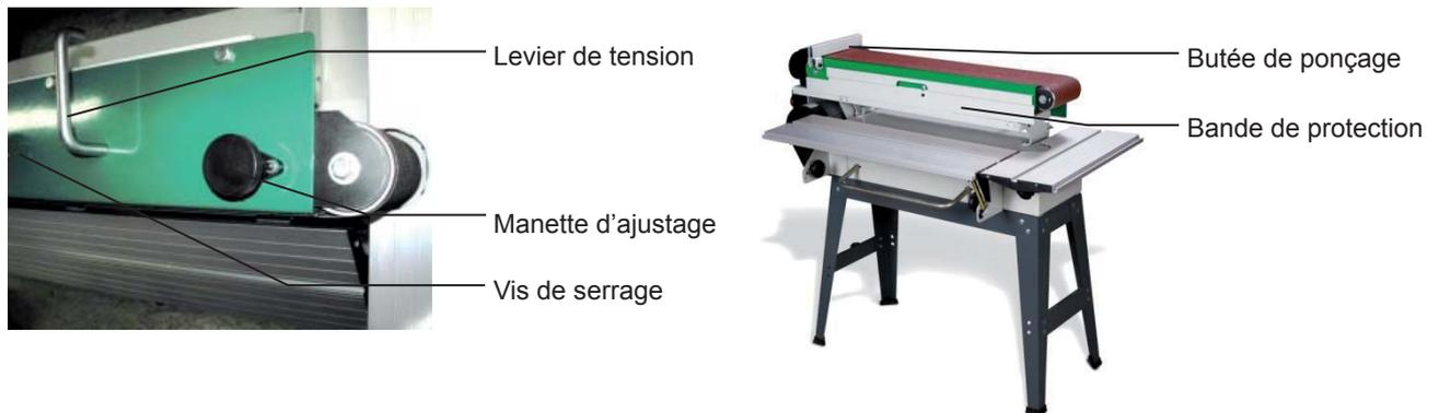
Le levier de tension permet de relâcher et de tendre la bande à poncer. Pour insérer une nouvelle bande, le levier doit être parallèle à la bande.
