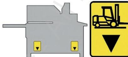
Fig. 5 Points de levage pour élévateur à fourche
