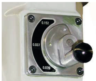
Fig. 4-1 : Sélecteur de vitesse d'avance du fourreau de la broche
