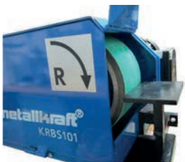
Fig. 20 : Sens de rotation de la bande R
