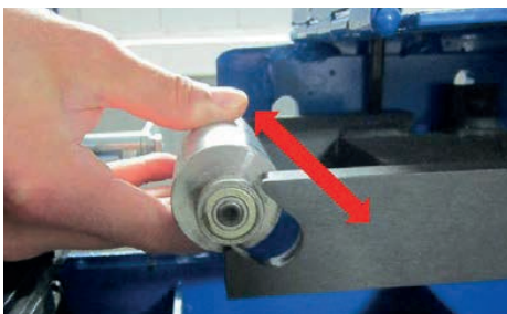
Fig. 23 : Changer le rouleau de contact
