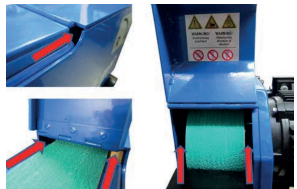
Fig. 16 : Ne mettez jamais les mains dans les ouvertures !
