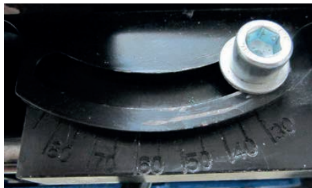
Fig. 10 : Dispositif d'inclinaison de la pièce à usiner
