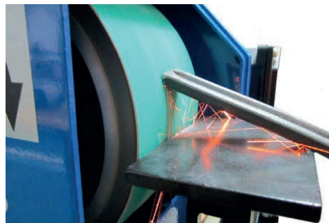
Fig. 21 : Les étincelles vont vers le bas si le sens de rotation est correct
