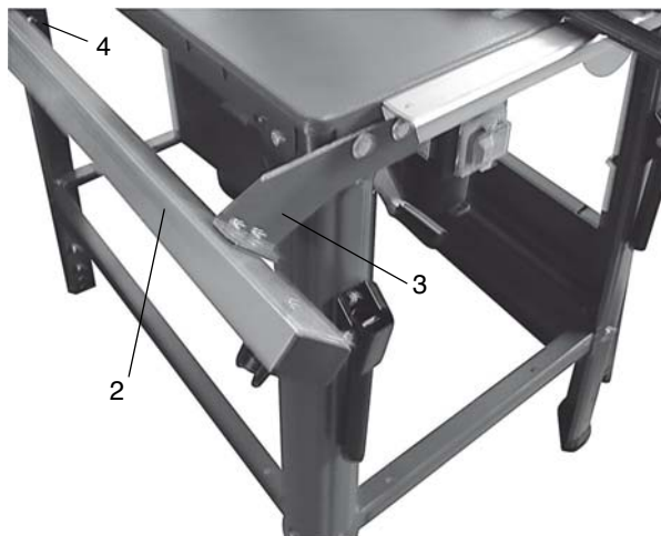
Fig. 21 : Montage des supports et du tube de guidage
