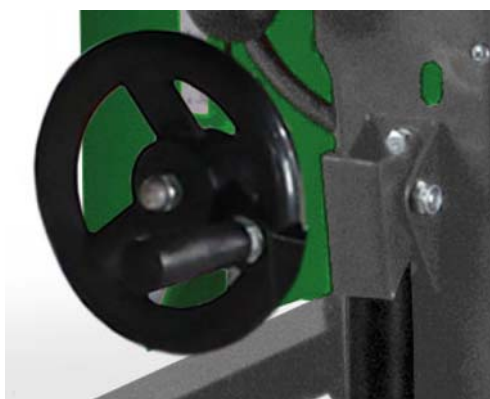
Fig. 17 : Réglage de la lame de scie
