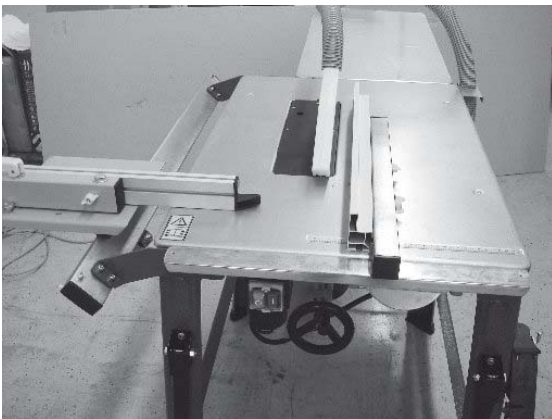
Fig. 25 : Alignement du plateau coulissant
