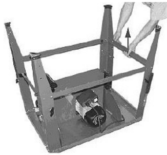
Fig. 5 : Montage des traverses
