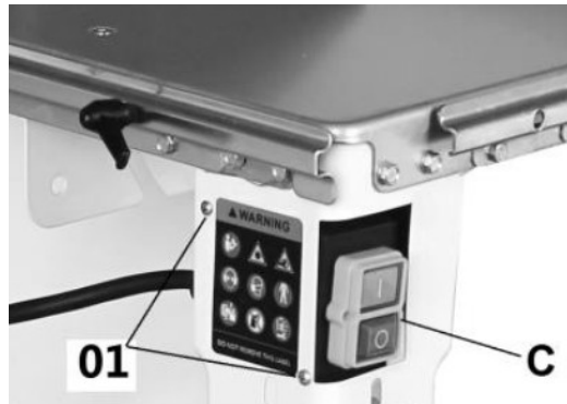
Fig. 9 : Montage de l'interrupteur
