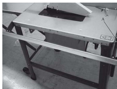
Fig. 22 : Installation du tube de guidage
