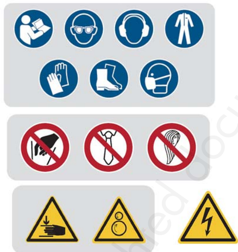
Fig. 4 : Marquages de sécurité sur la machine
