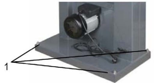
Fig. 4 : Ancre de la machine au sol
