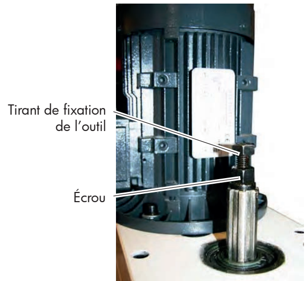
Fig. 4-2 Tête de perçage-fraisage sans carter de protection du tirant de fixation de l'outil
