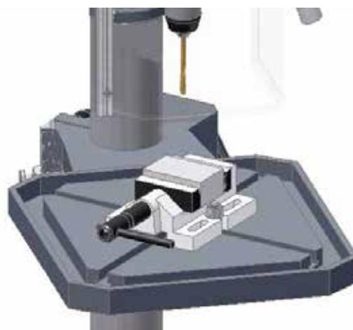
Fig. 4-1 Fixation d'un étau avec tasseaux en T
