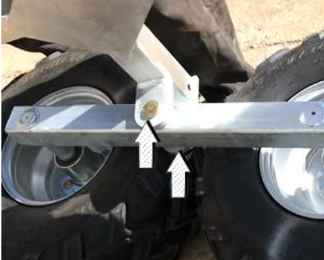
1 Assembleer en bevestig de wielstaaf op het frame Assemblez et fixez la tige de la roue sur le châssis Assemble and fix the stick of wheel on the frame
