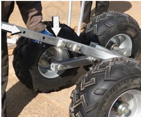
4 Steek de centrale buis in het frame en zet hem vast Insérez et fixez le tube central dans le châssis Insert and fix the center tube into the frame
