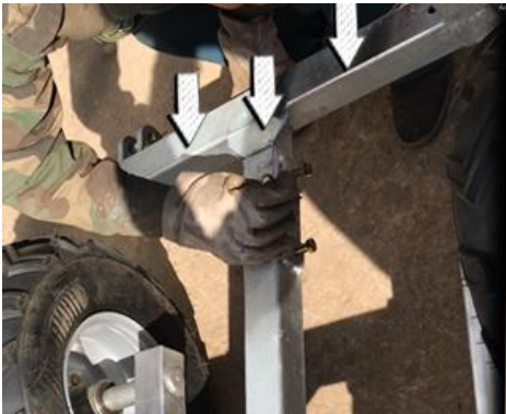
3 Steek de achterbuis in het frame en zet hem vast Insérez et fixez le tube arrière dans le châssis Insert and fix the rear tube into the frame
