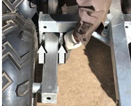
2 Assembleer en bevestig de wielstaaf aan de andere kant Assemblez et fixez la tige de la roue de l'autre côté Assemble and fix another side stick
