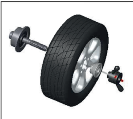
Axe principal-roue (Montage de la jante avec la face avant vers l'intérieur) Serrage rapide du cône (pointe vers l'intérieur)
