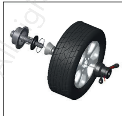
Hoofdas - veer (Reeds in de fabriek geïnstalleerd), Snelklemming van de conus (punt naar buiten gericht)
