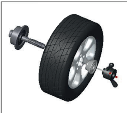
Hoofdas - wiel (Montage van de velg met de voorkant naar binnen gericht) Snelklemming van de conus (punt naar binnen gericht)
