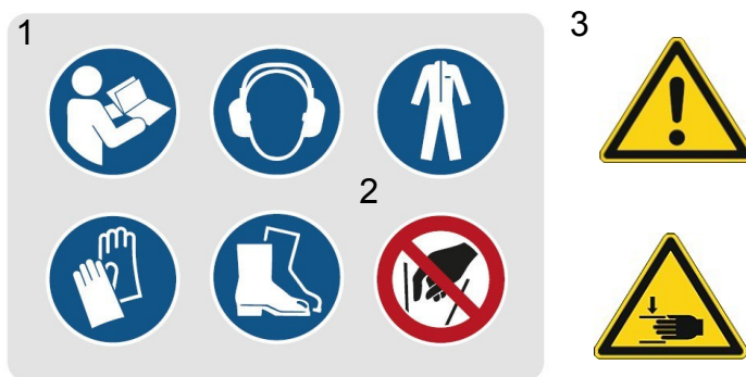
Fig.1-1: Marques de sécurité - 1 Signe obligatoire : Respecter le mode d'emploi, utiliser des protections auditives, utiliser des vêtements de protection, utiliser des protections pour les mains, utiliser des protections pour les pieds, 2 Panneau d'interdiction : Panneau d'avertissement : panneau d'avertissement général, avertissant des risques de blessures aux mains.
