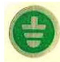
Figure 9 : notification de mise à la terre
