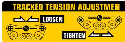
Figure 23 Réglage de la tension des chenilles :
