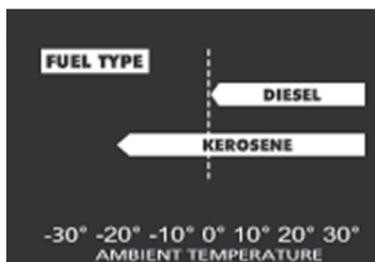
Bien que nos appareils de chauffage fonctionnent avec du diesel, lorsque les températures sont inférieures à 0 °C, des additifs diesel sont nécessaires pour maintenir la viscosité du diesel.
