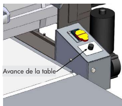
Fig. 18 : Réglage de la vitesse d'avance
