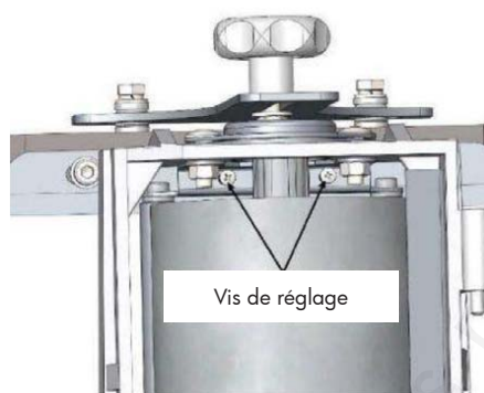
Fig. 26 : Vis de réglage rouleaux de pression
