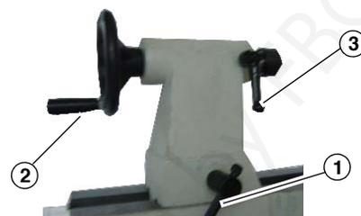
Fig. 13 : Réglage de la contre-pointe
