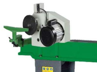
Fig. 15 : Porte-outil monté à gauche
