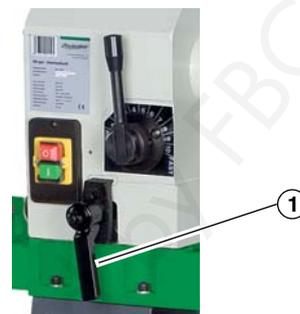
Fig. 7 : Montage du levier de serrage de la poupée fixe
