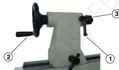
Fig. 10 : Remplacer la pointe tournante de la contre-pointe
