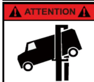
Placez le véhicule avec le centre de gravité au milieu des deux colonnes !
