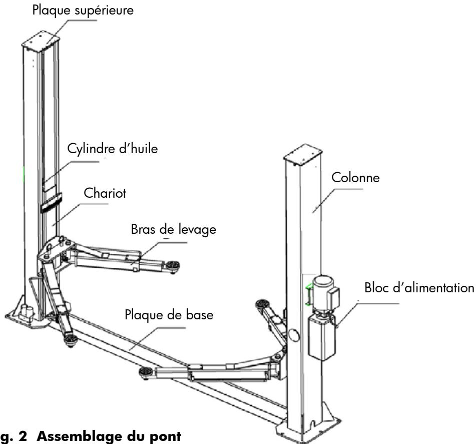
**Fig. 2 Assemblage du pont**
