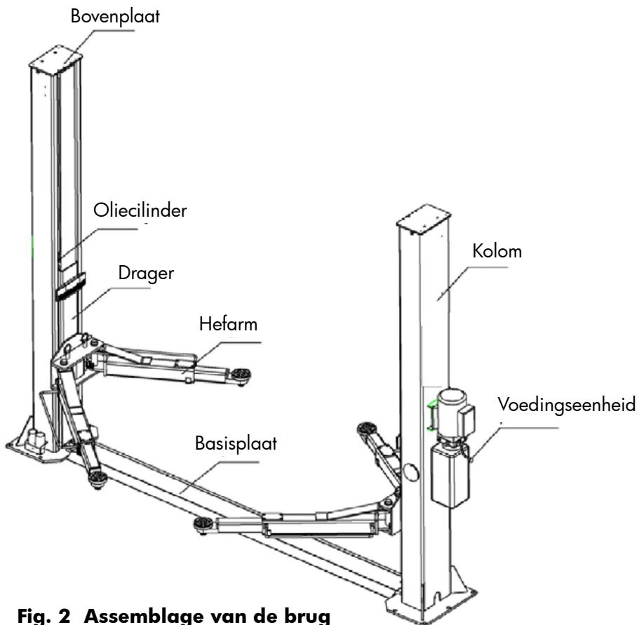
**Fig. 2 Assemblage van de brug**
