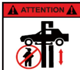
Restez loin du pont pendant la montée ou la descente du pont !
