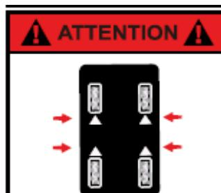
Utilisez les points de contact indiqués par le fabricant du véhicule !
