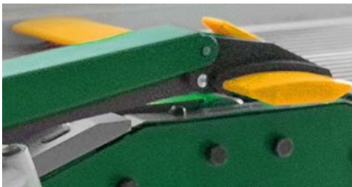
Fig. 2 : Pont de protection de l'arbre de la raboteuse
