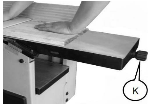
Abb. 22 : Réglage de l'enlèvement des copeaux
