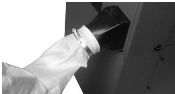
Fig. 14 : Assemblage du sac à copeaux
