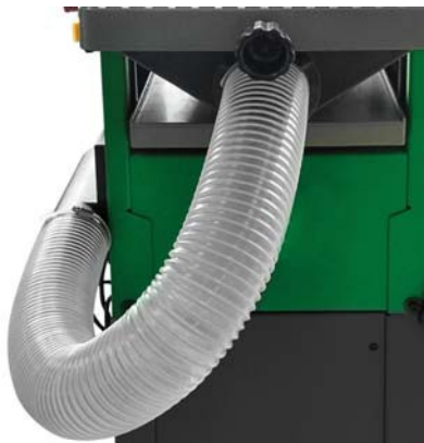
Fig. 15 : Montage du tuyau d'aspiration
