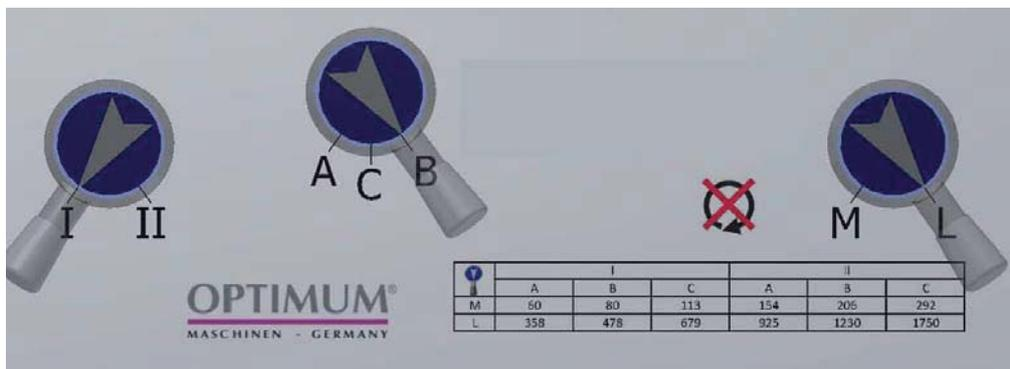
Fig. 4-7: Réglage à 478 min<sup>-1</sup>
