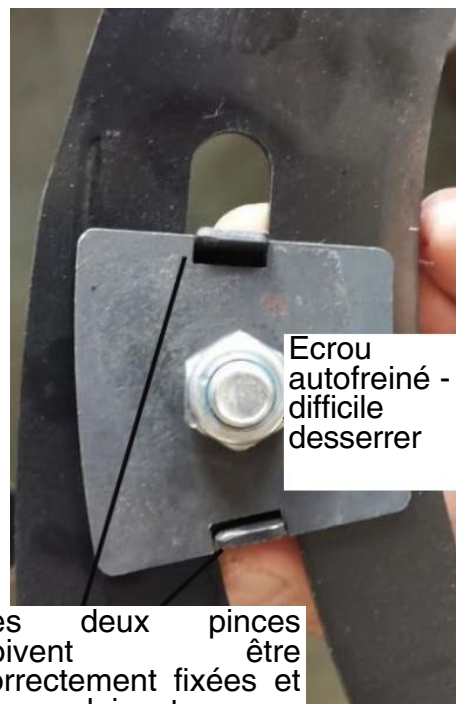
Fig. 20 : Montage du couteau diviseur, partie 1
