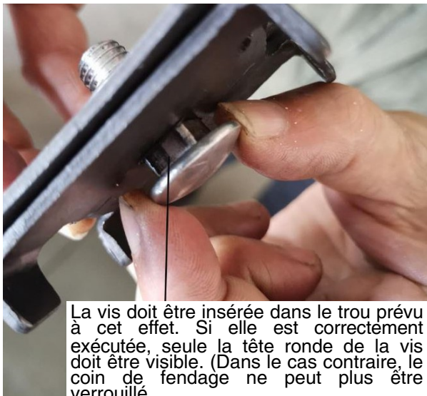
Fig. 19 : Montage du couteau diviseur, partie 1
