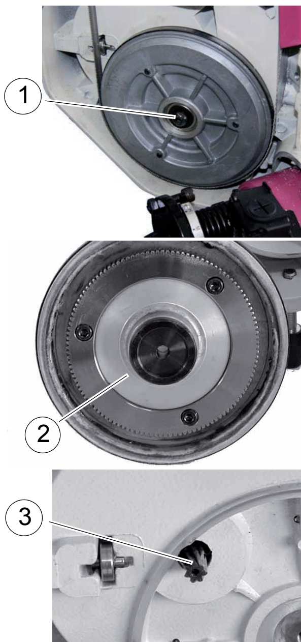
III.6-1: Lubrification de l'entraînement
