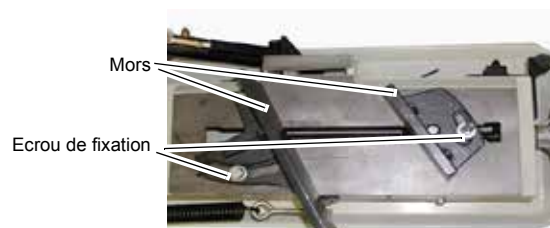
Image 4-4: Scier sous angle
