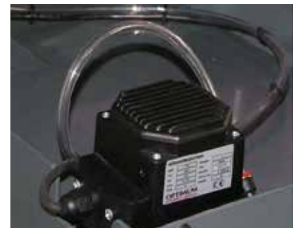
Fig. 4-12: Pompe de refroidissement
