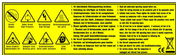
Fig. 1 : Marques de sécurité sur le compresseur
