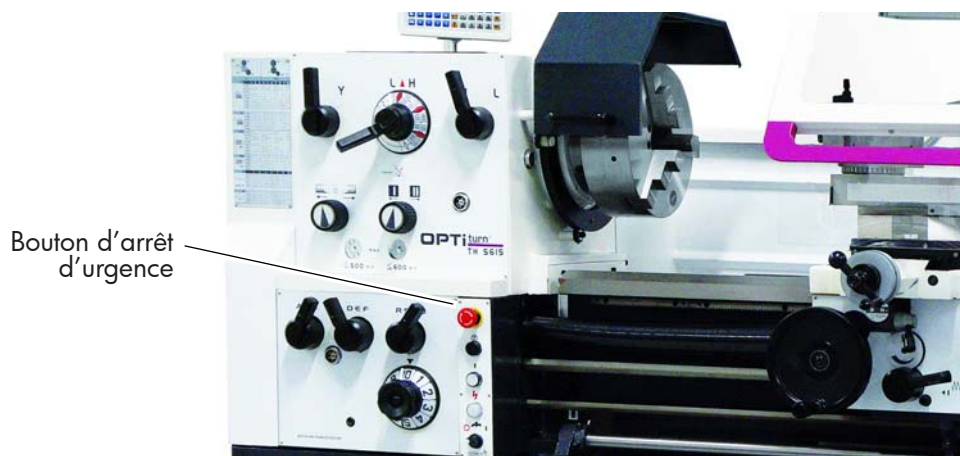
Fig. 1-2 Bouton d'arrêt d'urgence
