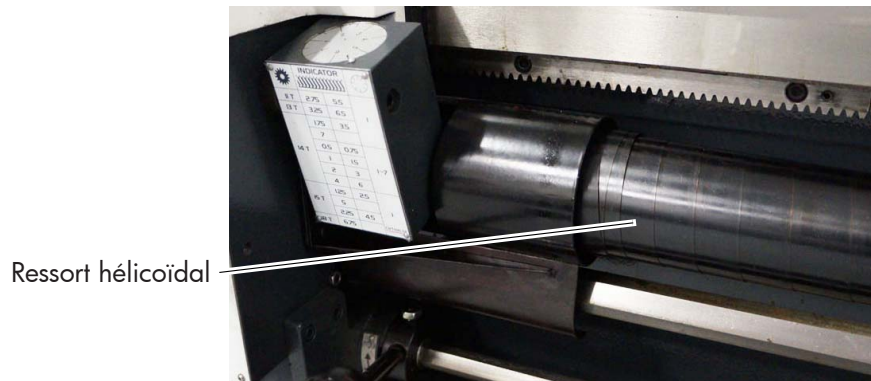
Fig. 1-6 Vis-mère avec protection
