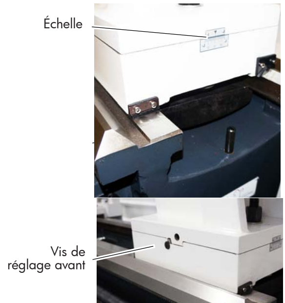
Fig. 4-14 Déplacement latéral contre-pointe
