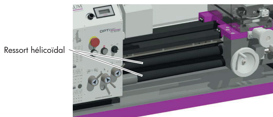
Fig. 1-4 Vis-mère et barre de chariotage avec carter de protection
